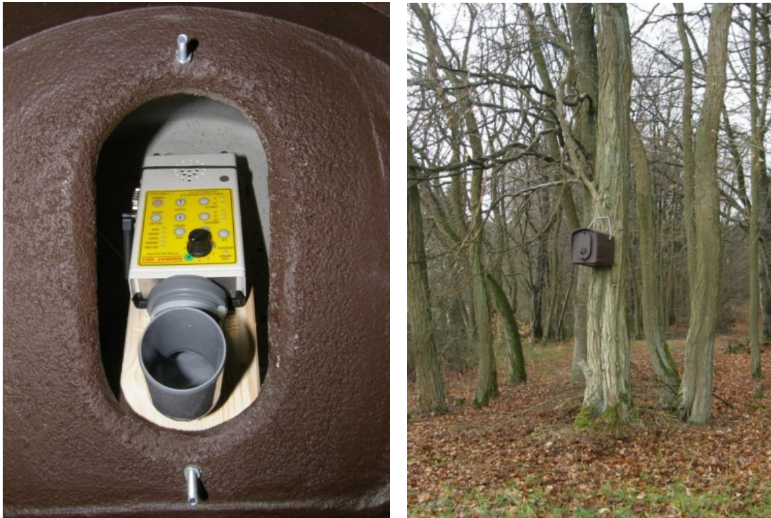
Abb. 3: Detailansicht des Aufnahmesystems installiert in der Dohlennisthöhle und am Baum angebrachtes Aufnahmesystem (hier am Anabat-Standort 4)
