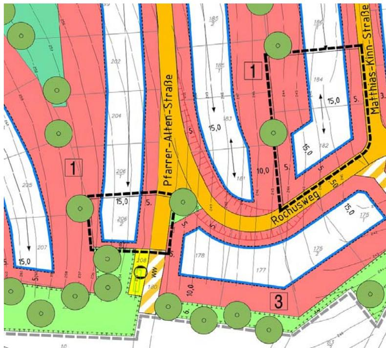
Abbildung 2 2. Änderung des Bebauungsplanes (mit aktuellem Kataster nach der Umlegung)
