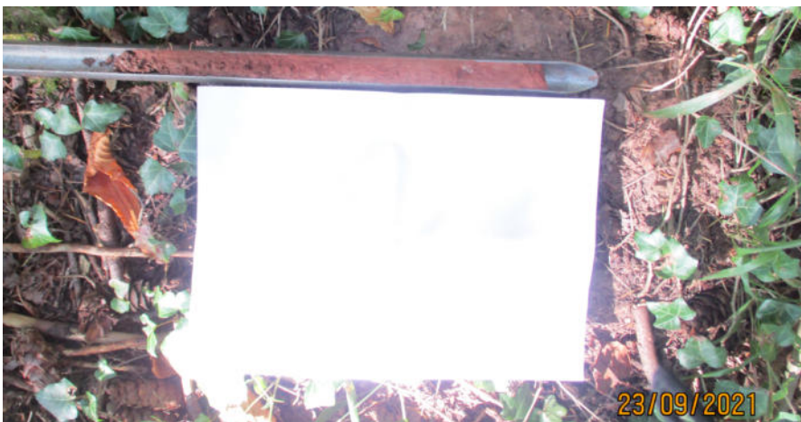
Abb. 7 + 8: Bohrstockproben mit Din A 4 Blatt als Maßstab (Teil an Bohrstockspitze leer, da trockener Boden beim Rausziehen abfiel, gehört aber zur Eindringtiefe dazu).
