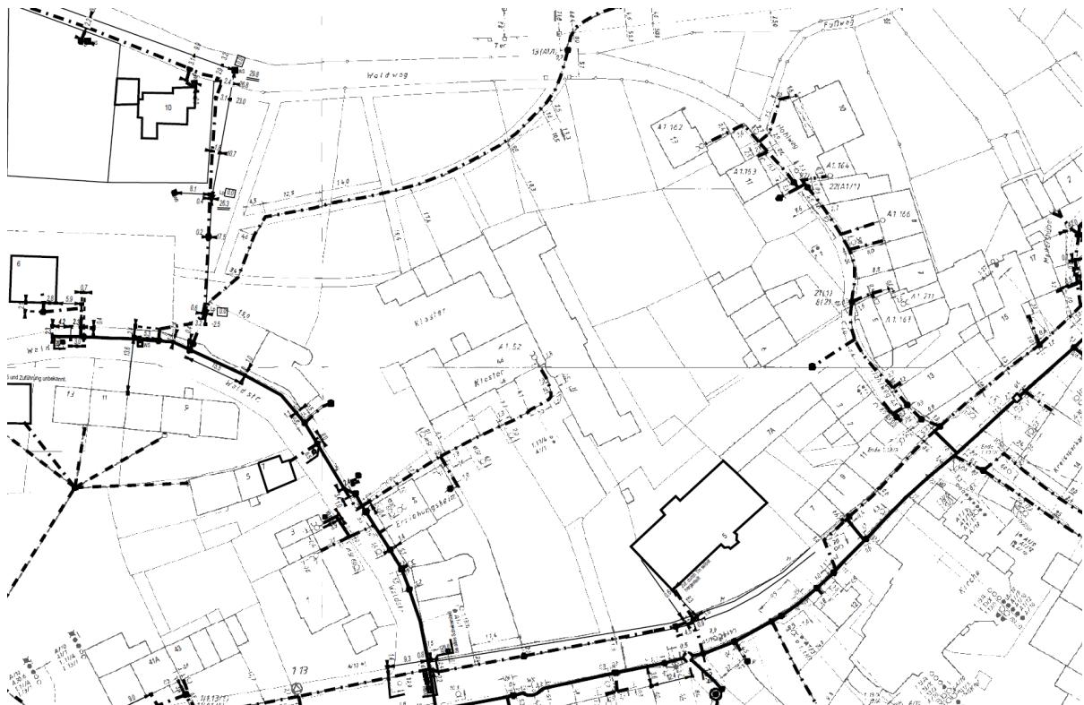
Abbildung 15: Lage Bestandsleitung Deutsche Telekom
