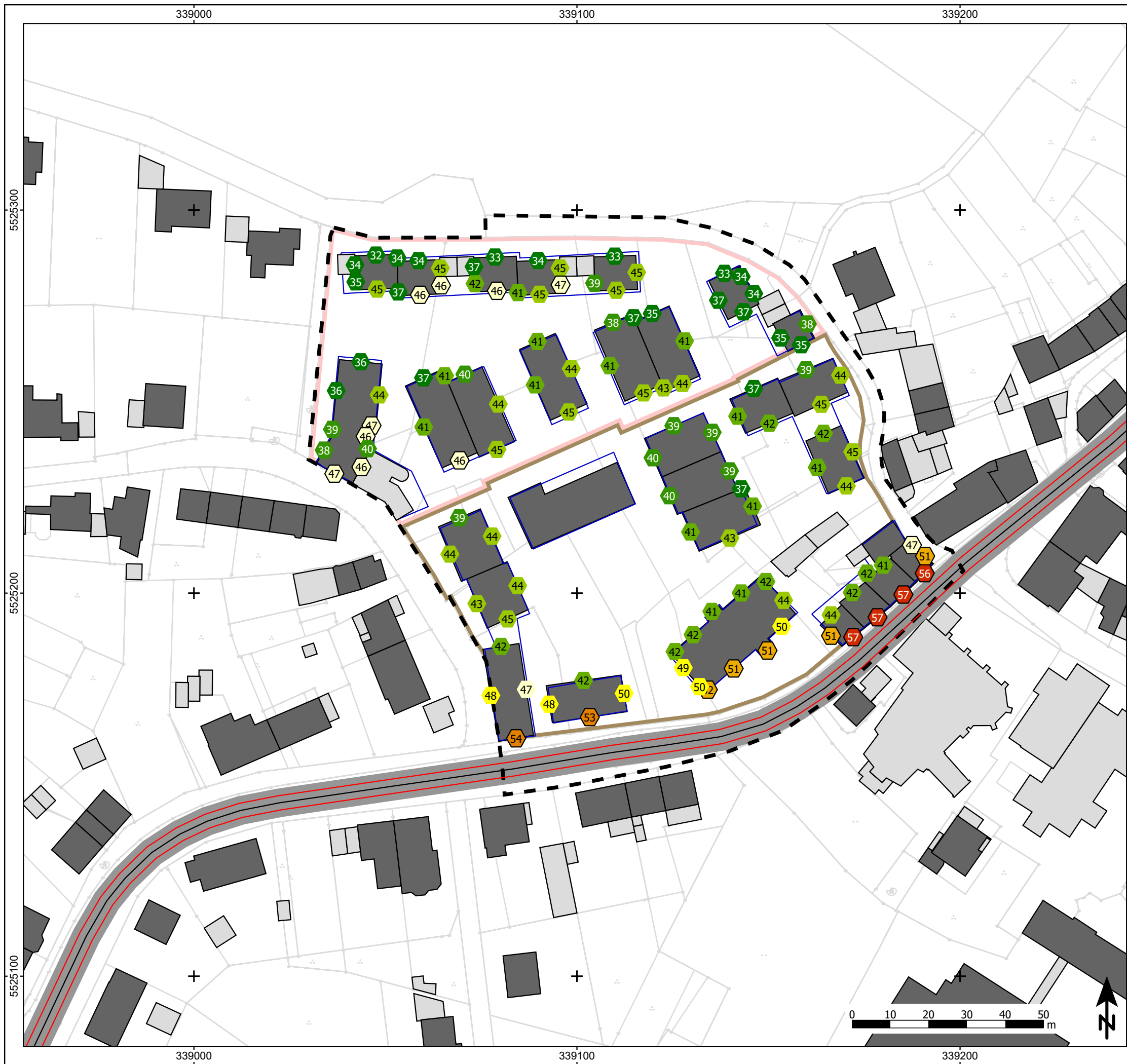
Abbildung A08 Verkehrslärm Gebäudelärmkarte, höchster Pegel an der Fassade Beurteilungszeitraum Nacht (22.00-06.00 Uhr)
